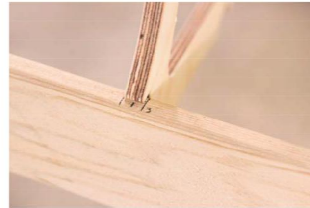
1 - Platzierung der Spanten zwischen den Markierungen
