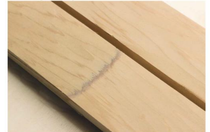
6 - die Schäftung nach dem Schleifen
