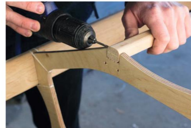
1 - Loch bohren (bei Spant 4)
