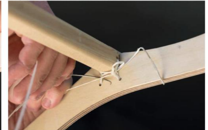
4 - Legen der Sehne und zusammenziehen des Knotens
