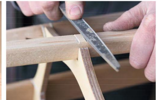
2 - versenken der Sehne in Kerben
